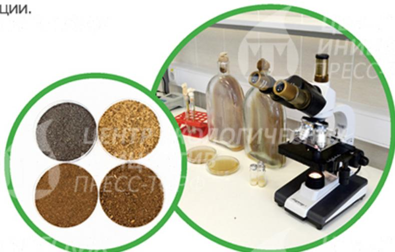
**Основные свойства биосорбентов:** способность осуществлять биодеструкцию сорбированных нефтепродуктов до нетоксичных соединений, возможность проведения утилизации загрязнений на месте применения, способность обеспечивать очистку воды и почвы при температурах окружающей среды от +2°C до +40°C, сохранение сорбционной способности сорбента под снегом и восстановление биодеструктивной активности после зимнего периода.
